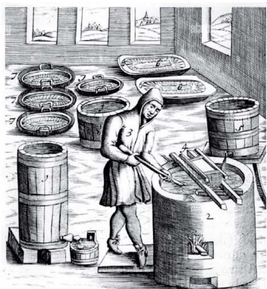
La cristallisation du salpêtre. À partir de 1683 de l'édition anglaise de 'mineralischen Ertzt allerfurnemisten Beschreibung', Lazarus Ercker, (Prague, 1574).
